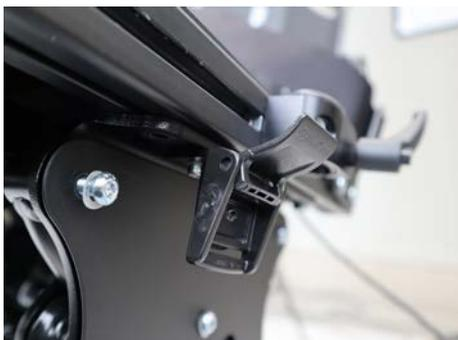
Para la parte anterior del cinturón, las hebillas plegables deben ser anteriormente fijadas en la parte inferior del sistema de perfiles.
