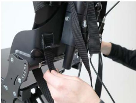
Pasar las cintas inferiores por debajo del respaldo desde adelante hacia atrás y pasar los mismo por las hebillas a ventana sobre el perno de bloqueo de la regulación de la inclinación del respaldo.
