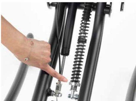
El amortiguador está calibrado a una fuerza pre seleccionada. Es posible reajustarlo en caso de ser necesario. Véase también la sección 5. 36 Amortiguador (página 34.)
