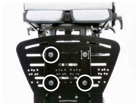
Luego de aflojar los tornillos ilustrados en la imagen, el apoya pies puede ser regulado por deslizamiento en la profundidad deseada.
