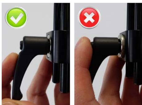
Asegúrese que el distancial plateado entre en la sede del anclaje correctamente, y que quede al mismo nivel que el anclaje negro. A la izquierda un ejemplo del inserto bien colocado a izquierda, y mal colocado a derecha.
