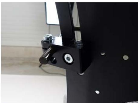
Abriendo el conector del soporte ilustrado, es posible regular su profundidad, ancho y altura.
