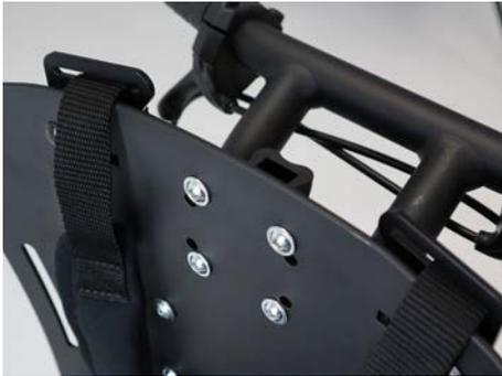
Pasar las cintas inferiores a través por los canales en la parte inferior de la plancha posterior de la base hacia atrás. Pasar las cintas inferiores a través por los canales en la parte inferior de la plancha posterior de la base hacia atrás.
