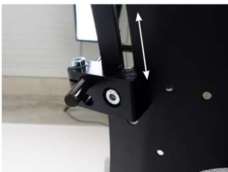
El ajuste en altura se realiza aflojando el bulón tornillo de conexión mostrado y deslizando toda la unidad por la ranura sobre la plancha del respaldo.
