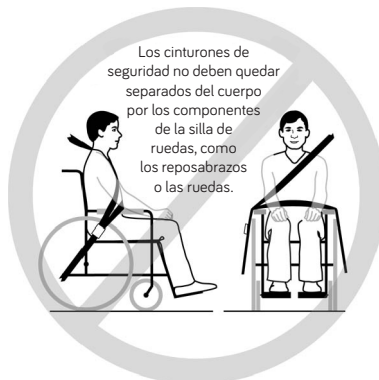
Figure 3a - Colocación incorrecta de las restricciones del cinturón pélvico sobre los soportes de las sillas de ruedas.
