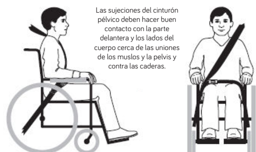
Figure 3b - Enrutamiento y posicionamiento correctos de los cinturones de seguridad en el ocupante de la silla de ruedas.
