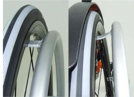
Todos los aros de propulsión pueden montarse cerca de la rueda trasera o un poco más separadas. Se puede modificar a posteriori.
