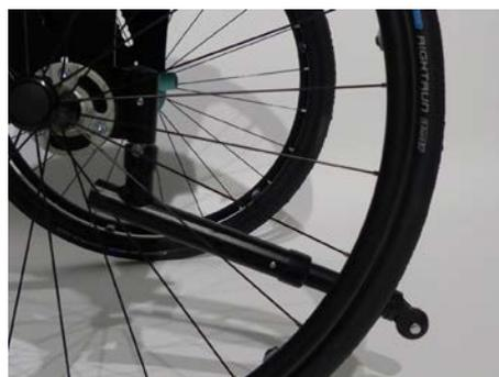
Presione el botón a presión y elija la posición de longitud deseada. La longitud de los tubos antivuelco se puede ajustar en el soporte antivuelco en tres posiciones con una separación de 2,5 cm.
