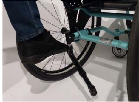
CESA también se puede equipar con dos dispositivos antivuelco premontados. La ilustración muestra un dispositivo antivuelco en la posición "activa".
