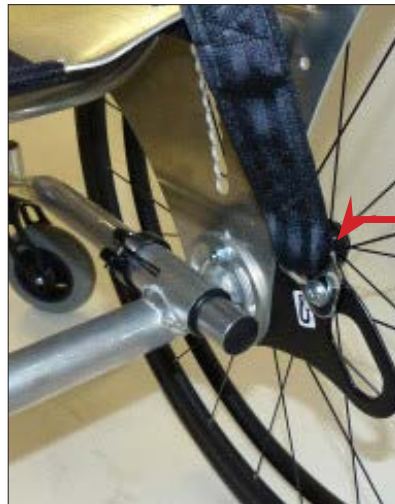
Puntos de fijación, traseros según ISO 7176-19 para cinturón de seguridad
