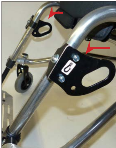
Puntos de fijación, delanteros según ISO 7176-19
