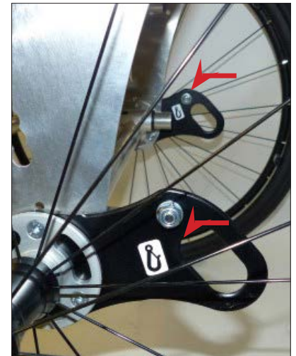
Puntos de fijación traseros según ISO 7176-19
