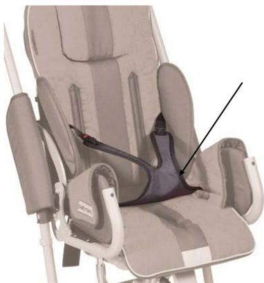
**Montaje:** pase las correas con velcro por estos orificios (TOM: pase las correas con velcro por el espacio entre la tapicería del respaldo y el asiento). Ate las correas detrás del tubo trasero del asiento y asegúrelas con velcro.
