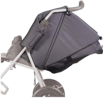
**Montaje:** la protección lateral extendida se desliza sobre el respaldo y se coloca en los tubos de ambos lados de la empuñadura con la ayuda de cuatro bucles de plástico. Coloque un par de bucles superiores colocados entre la faja de plástico de la empuñadura y su perilla. Las solapas de la protección lateral extendida se aseguran con cierre de velcro. La parte inferior de la protección lateral extendida asegurada con cuerdas.
