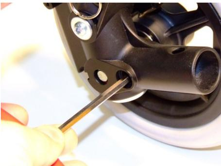
La presión de los frenos de fricción y, por lo tanto, la velocidad de rodadura de los neumáticos se puede variar aflojando o apretando los tornillos de fijación interiores.
