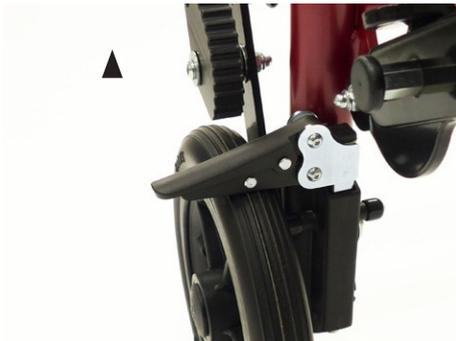
Para el bloqueo, el soporte de sujeción superior se baja sobre la rueda presionado hasta que el freno encaje de forma segura.
