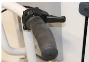
Palanca ajuste basculación montada en empuñaduras
