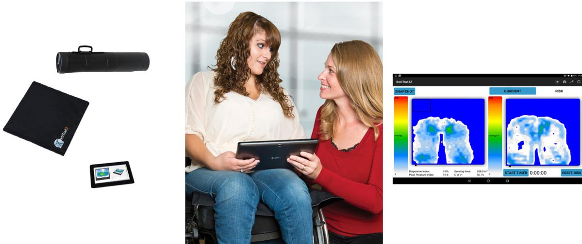
BodiTrak2 Lite és un **sistema de monitorització de la pressió i les forces de cisalla, que s'aplica sobre una superfície de seient**. Utilitza sensors elàstics d'última generació, amb electrònica USB integrada: flexible, elàstica, portàtil, de fàcil ús i a l'abast de tots.
